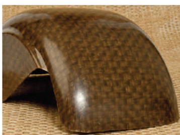
Carrosserie en Nattex® (roving de fibre de lin).
